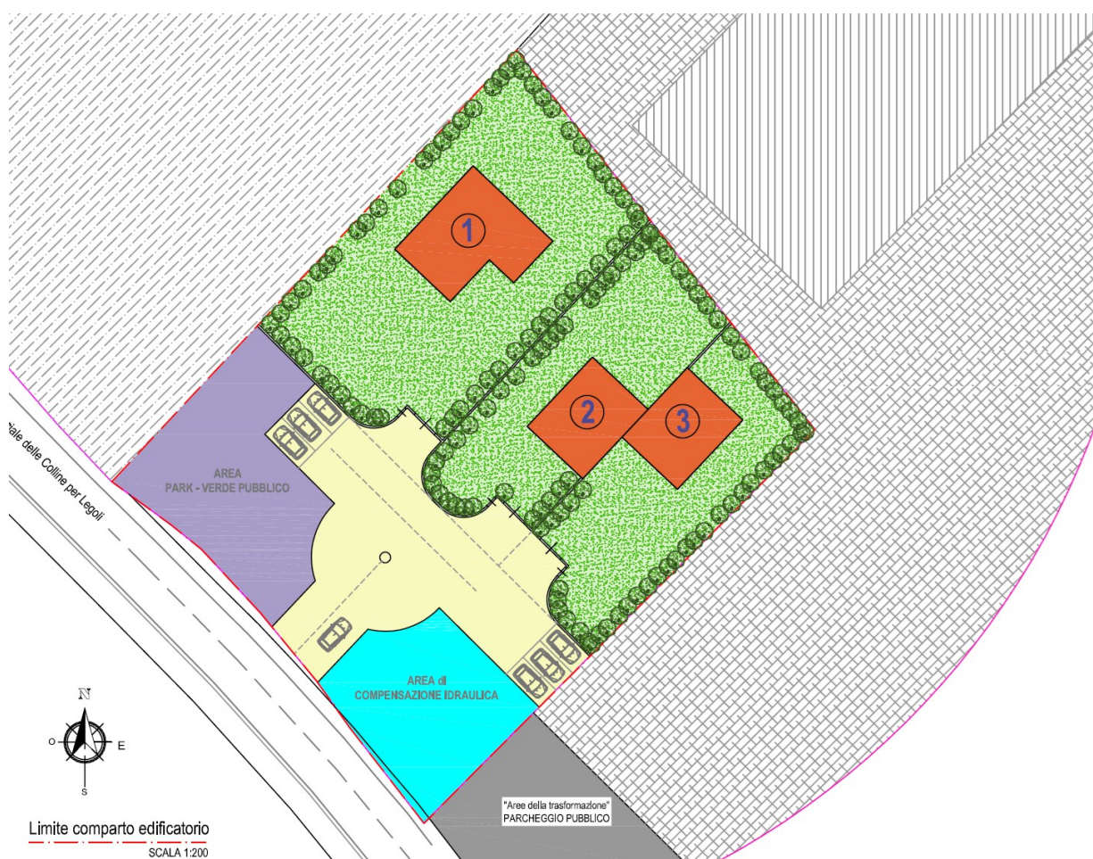
Schema di assetto insediativo del comparto con localizzazione dell'area di compensazione idraulica prevista dalla scheda norma
